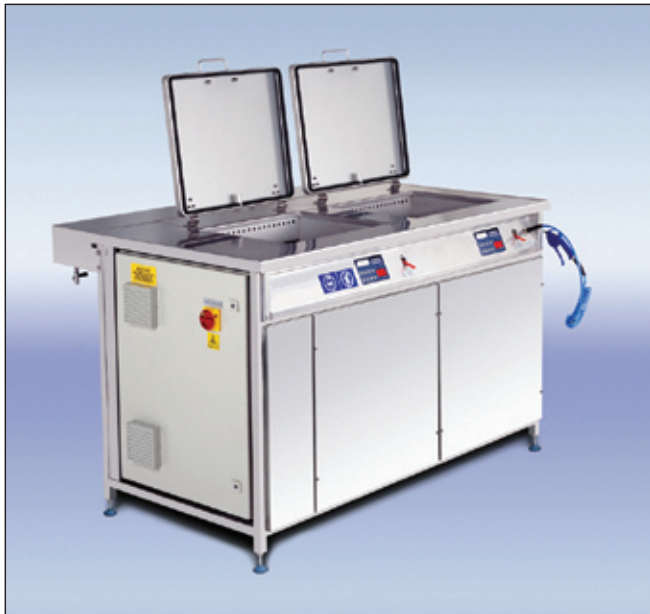
Фото 2. Ультразвуковая установка для очистки от загрязнений формообразующих деталей оснастки для переработки ПМ
